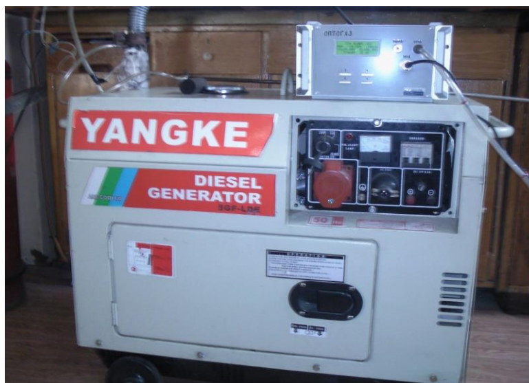
Сурет 3.6. Дизель-генератор негізіндегі каталитикалық қондырғы
