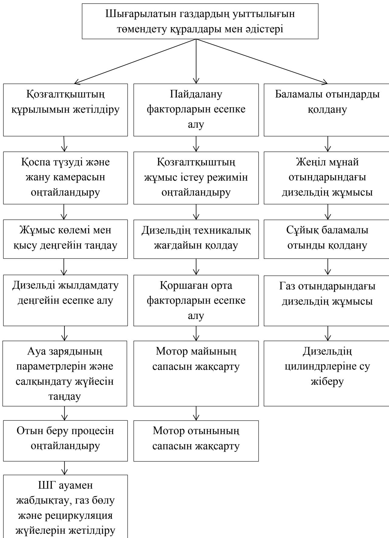
Сурет 1.2. Дизельден шығарылатын газдардың уыттылығын төмендетудің негізгі құралдары мен әдістерінің сызбасы
