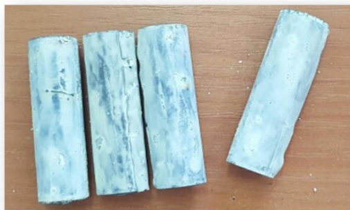
Сурет 3.2. Екіншілік тасымалдағышы бар катализаторлардың зертханалық үлгілері
